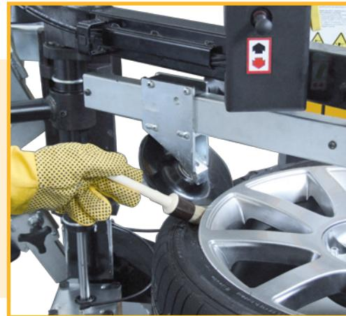
**IT** La pressione del disco agevola l'inserimento della leva alza-talloni e facilita lo smontaggio
