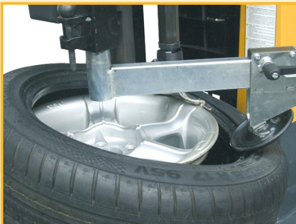
**IT** Il disco del braccio rotante facilita il montaggio.
