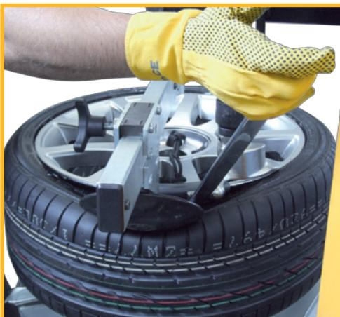
La pressione del disco permette al tallone di scivolare facilmente **IT** sulla testina di smontaggio
